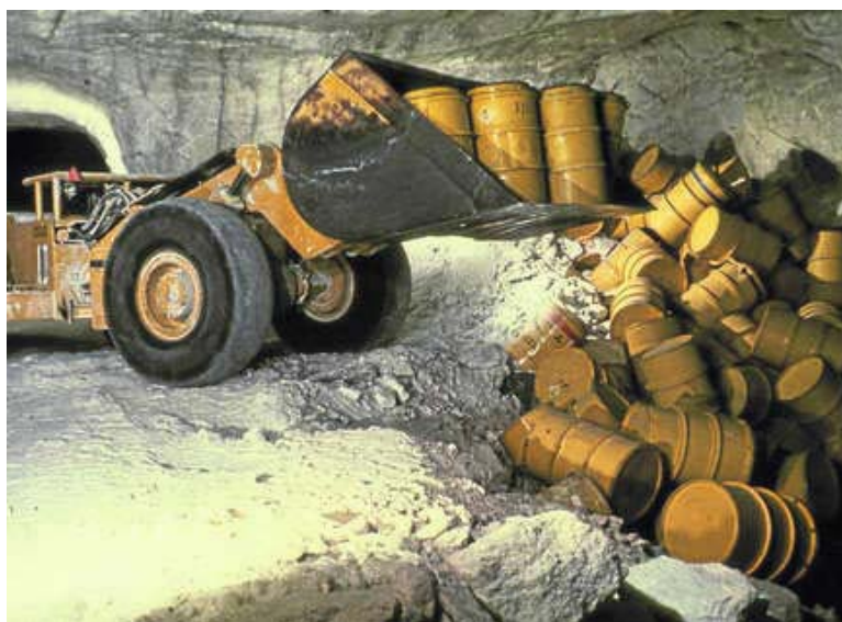
Figure 24 Tonneaux en acier remplis par des déchets radioactifs et stockés dans l'ancienne mine de sel Asse II à Wolfenbüttel en Basse-Saxe
